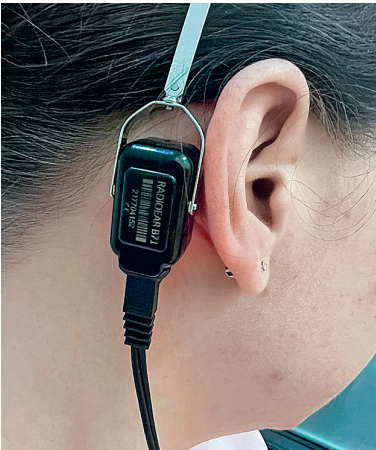
Рис. 3.12. Расположение костного телефона на площадке правого сосцевидного отростка пациента при определении порогов слуха костного звукопроведения (из архива авторов)
