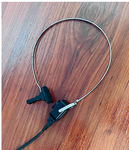
Рис. 3.7. Костный телефон (B71) для определения порогов слуха по кости в диапазоне частот 250–6000/8000 Гц (из архива авторов)
