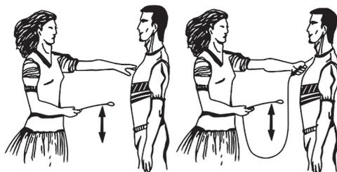
Простейший сенсор можно изготовить из подручных материалов, например из упругого прута с грузом на конце. В качестве груза можно использовать шариковую ручку.
