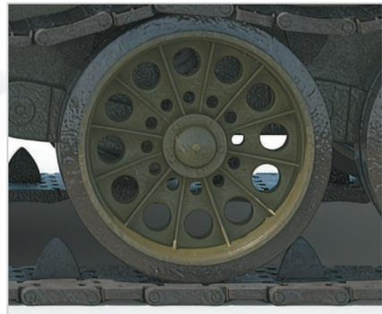
■ Второй характерной чертой конструкции являются крупные «автомобильные» катки-«колеса». Они устанавливались на танк с расчетом, что он будет двигаться в том числе и без гусениц.
