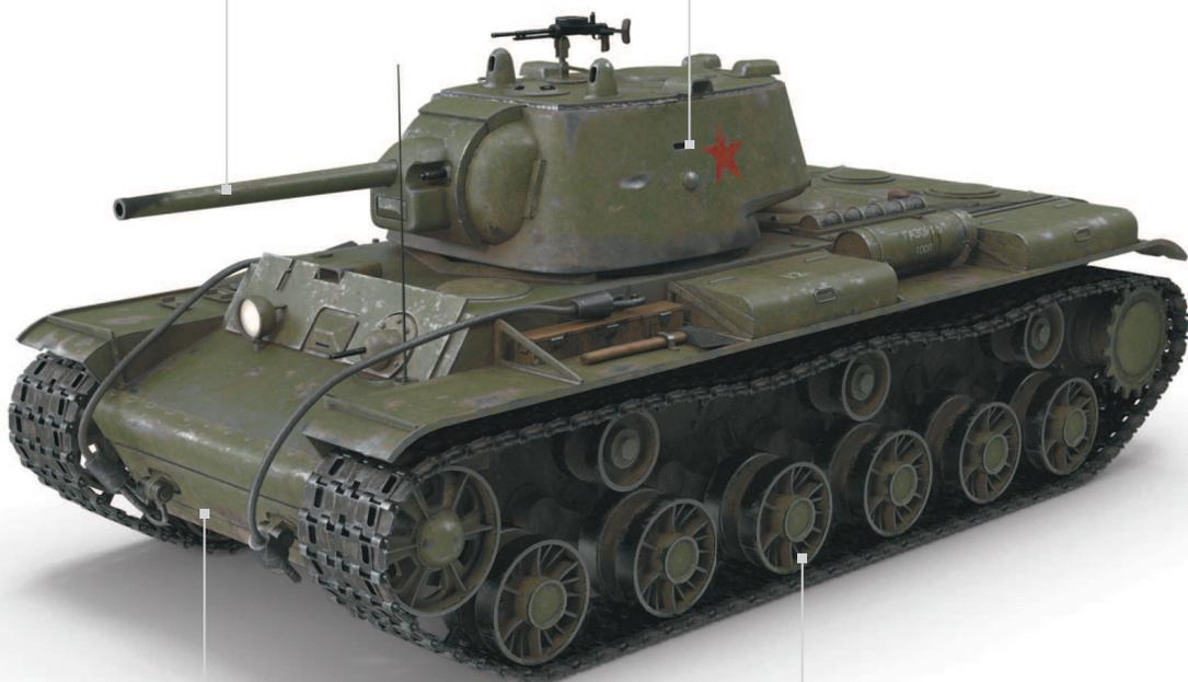
**БРОНЕКОРПУС:** имел рекордное для своего времени бронирование — 90 мм в передней части.
