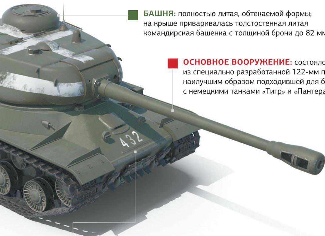
**БАШНЯ:** полностью литая, обтекаемой формы; на крыше приваривалась толстостенная литая командирская башенка с толщиной брони до 82 мм.
