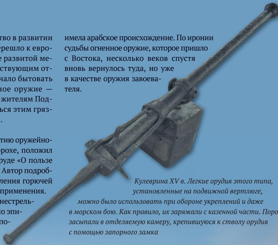
*Кулеврина XV в. Легкие орудия этого типа, установленные на подвижной вертлюге, можно было использовать при обороне укреплений и даже в морском бою. Как правило, их заряжали с казенной части. Порох засыпали в отделяемую камеру, крепившуюся к стволу орудия с помощью запорного замка*
