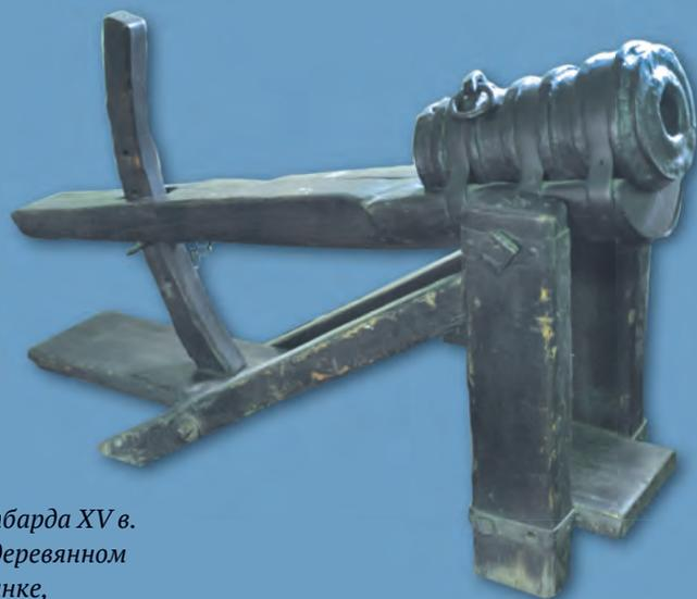
*Бомбарда XV в. на деревянном станке, позволяющем менять угол наклона ствола и производить вертикальную наводку*
