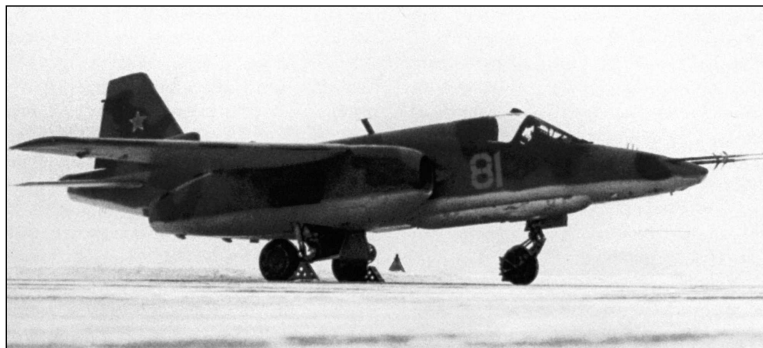
Т8-1 на аэродроме ЛИИ МАП. Под кабиной виден обтекатель встроенной пушечной установки ВПУ-22
