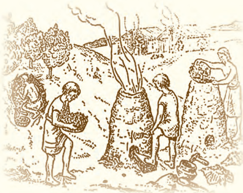
Сыродутная печь представляла собой полое сооружение из камней, обмазанных глиной, или целиком из глины. В стенах были предусмотрены отверстия для раздувания мехами
