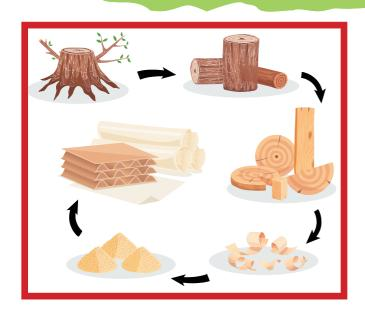
Бумагу делают на бумажных фабриках. В качестве сырья используется дерево различных пород, например сосна или тополь. Брёвна очищаются от веток и коры и измельчаются до тонких волокон. Измельчённое дерево отправляется вариться в котле с водой и кислотами.
