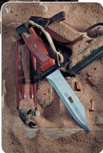
Положа руку на сердце, это уже совершенно иной штык-нож, мало похожий на своего предшественника. Пожалуй, сходство осталось лишь в форме ножен и наличии характерного отверстия на клинке. Изменилась форма клинка и рукояти, материал, из которого изготавливаются рукоять и ножны, а также форма крепления — теперь русский штык-нож расположен в горизонтальной плоскости справа от нового автомата Никонова АН-94, принятого на вооружение Российской армии.
