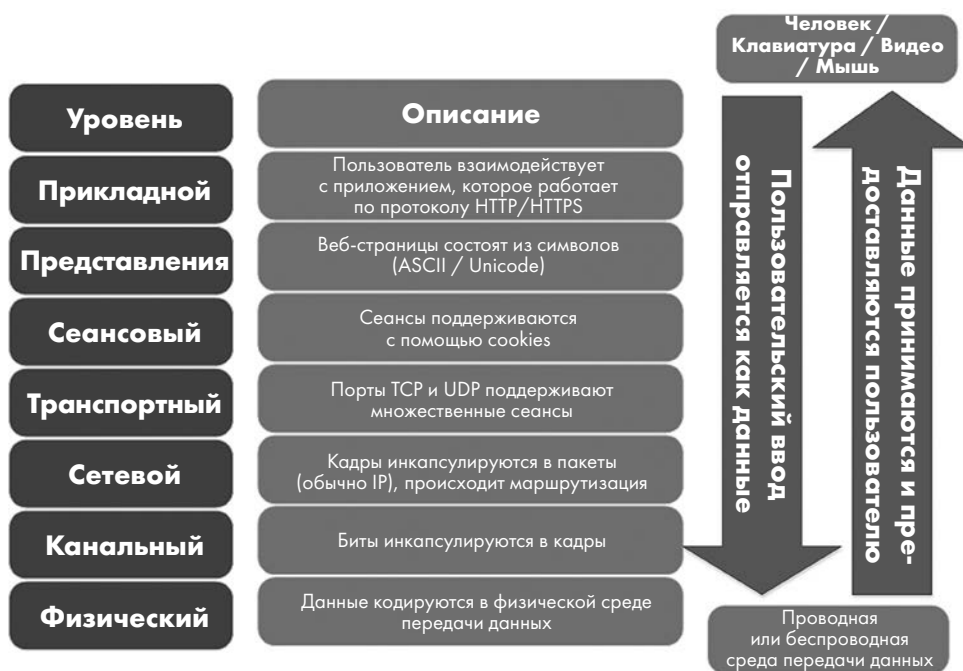
Рис. 3.2. Перемещение вверх и вниз по стеку OSI с инкапсуляцией и декапсуляцией по мере продвижения
