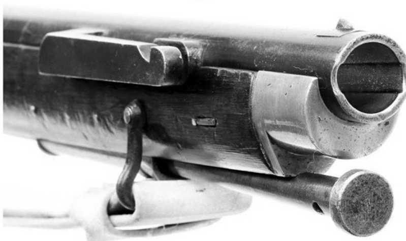
Брауншвейгский нарезной штуцер Бернера, принятый на вооружение Британской Армии под наименованием винтовка Брунsvик Mod. 1837. На фото наглядно видны два нареза по которым проходила круглая пуля с пояском
