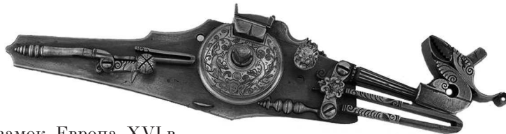
Искровой колесцовый замок. Европа, XVI в.
