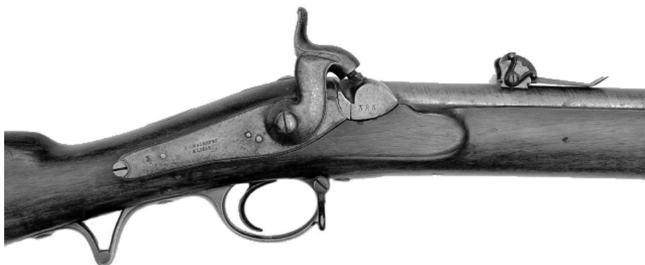
Капсюльный замок Литтихского штуцера и так называемый гессенский прицел
