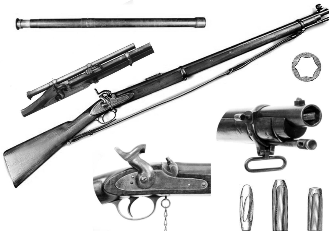
Винтовка Витуорта (Витворта) М 1857, один из первых оптических прицелов, капсюльный замок винтовки, разрез ствола с шестью нарезами, дульная часть винтовки и варианты гексагональных пуль конструкции Витуорта
