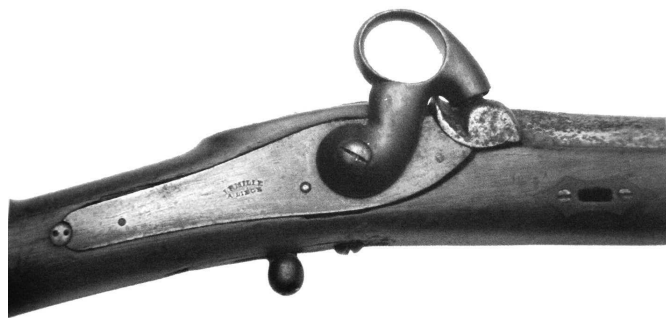
Капсюльный замок 6-линейной казачьей винтовки обр. 1860 г. Льеж (Бельгия). Заказ 1864 г.
