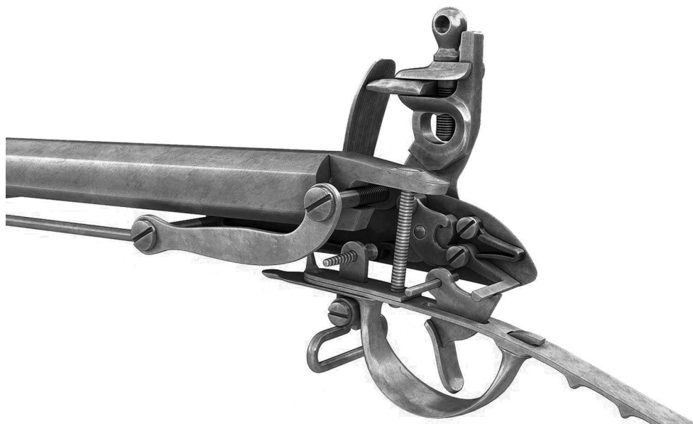
Устройство кремнёвого замка русского пехотного ружья 1808 года
