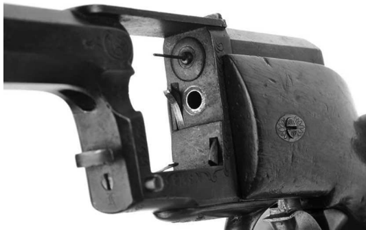
Револьвер Дрейзе. При приведении в действие самовзводного механизма в окне рамы видна игла, выполняющая роль ударника
