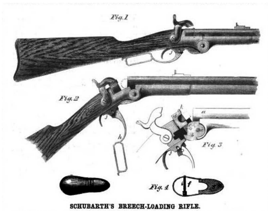
Принцип действия шпильчатой винтовки и патрона Шубарта М.1861
