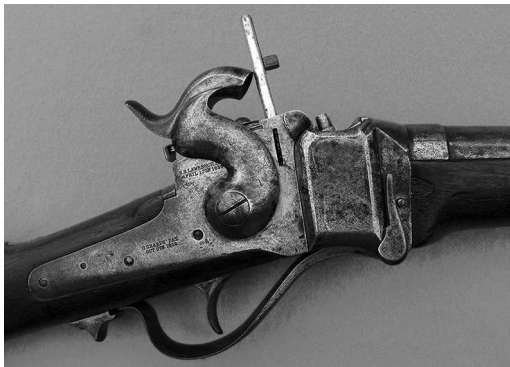
Фрагмент казённой части винтовки Шарпса М1859 со вставленной трубкой подачи капсюлей
