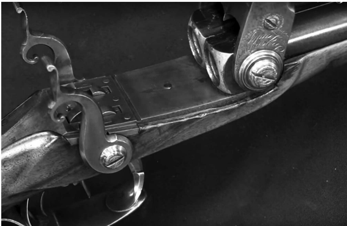
Казённая часть ружья Паули с видом на патронник при поднятой скобе-затворе
