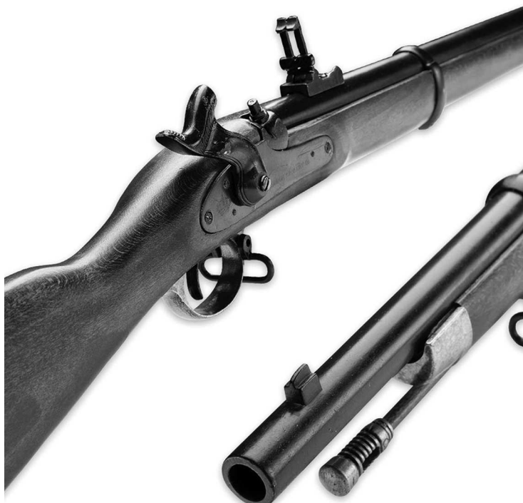
Винтовка Энфилд М. 1853 со взведённым курком (вид справа) и её дульная часть
