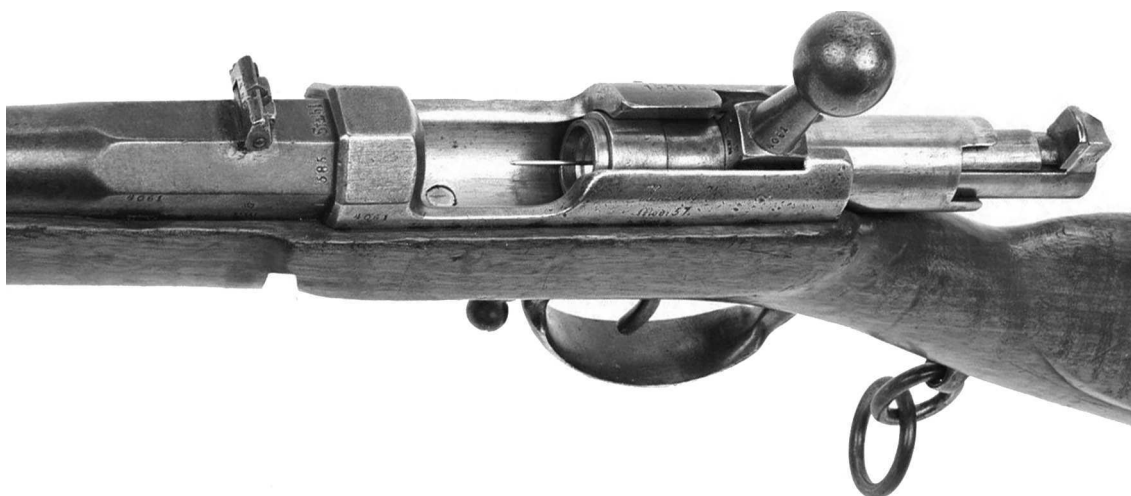
Казённая часть карабина Дрейзе Mod. 1857 с открытым затвором (хорошо видна выступающая игла, выполняющая роль ударника)
