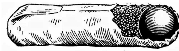
Устройство бумажного (не унитарного) патрона
