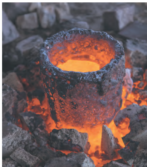
Тигель с расплавленной железной рудой
