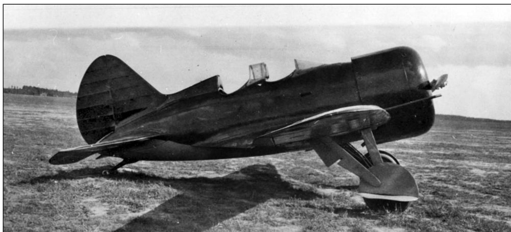
Учебно-тренировочный истребитель УТИ-2 М-22 с убираемым шасси. 1937 г.
