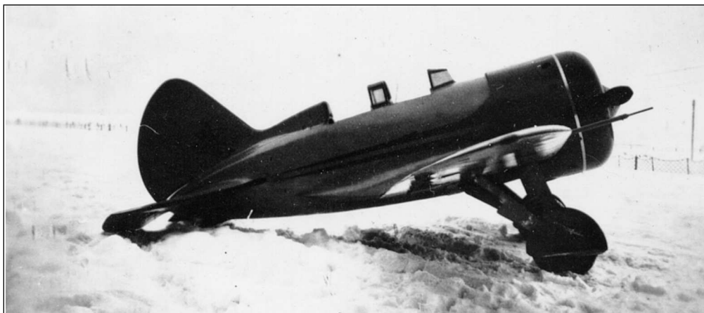
Учебно-тренировочный УТИ-3 № 11211, оснащенный двигателем М-58
