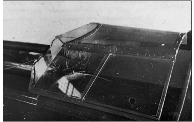
Надвигаемый фонарь пилотской кабины И-16 тип 4. Небольшое видимое отверстие являлось упором при открытии боковой форточки
