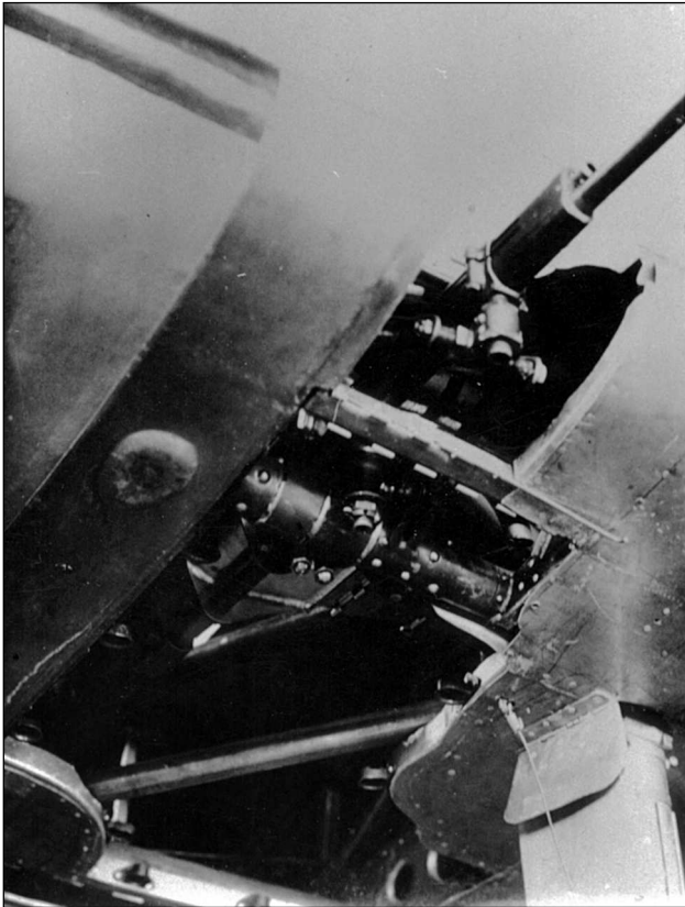
Справа: прицел ОП-1 с цилиндрическим упором для глаз из губчатой резины
