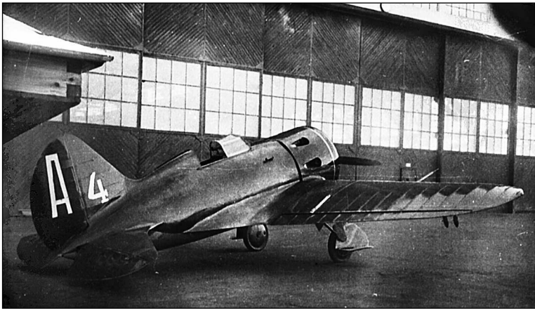
ЦКБ-12 №123954 у ворот ангара завода №39. Этот самолет, оснащенный двигателем Райт «Циклон» F-3, стал прототипом массовой серии И-16 тип 5
