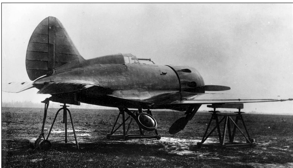
ЦКБ-12 бис с двигателем «Райт-Циклон» F-3 установлен на козелки для проверки механизма уборки шасси
