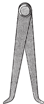
Рис. 41. — Кронциркуль для измерения внутренних диаметров (нутромер)
