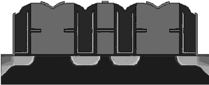
Рис. 1.9. Двухмерная модель однобитной NAND-ячейки флэш-памяти (1 — режим стирания заряда с плавающего затвора; 2 — чистая ячейка памяти (запись и стирание не проводилось); 3 — режим записи отрицательного заряда на плавающий затвор n -МОП-транзистора)
