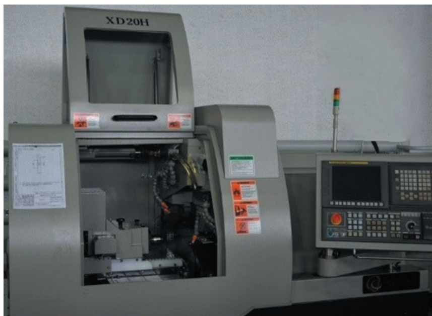
Рис. 1.5. Токарный прутковый автомат Hanwha XD20H с двумя шпинделями и системой линейных суппортов («швейцарский тип»)
