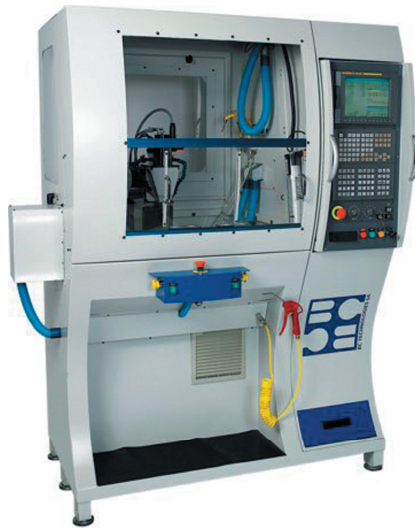
Рис. 1.2. Типичная компоновка ОЦ с ЧПУ по 5 осям и с 7-местным магазином для автоматической смены инструмента
