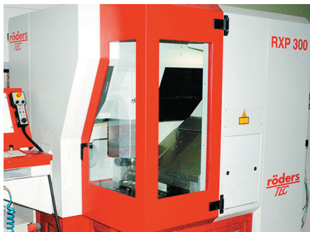
Рис. 1.4. Станок для микрообработки Roeders RXP 300
