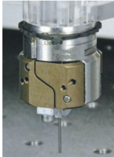
Рис. 1.15. Общий вид схвата, собранного из унифицированных узлов
