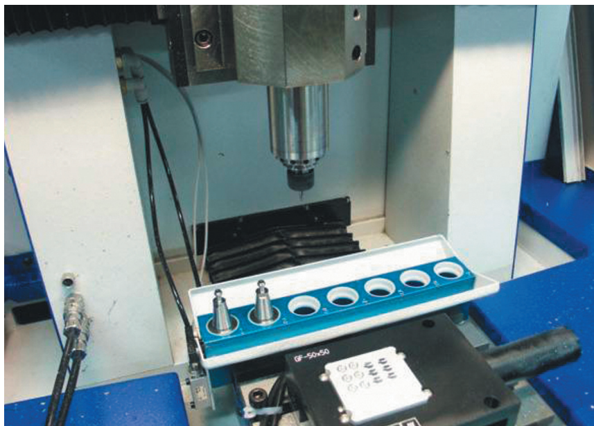
Рис. 1.12. Настольный станок с приспособлением для установки заготовок микродеталей с помощью специальных замораживаемых зажимных пластин
