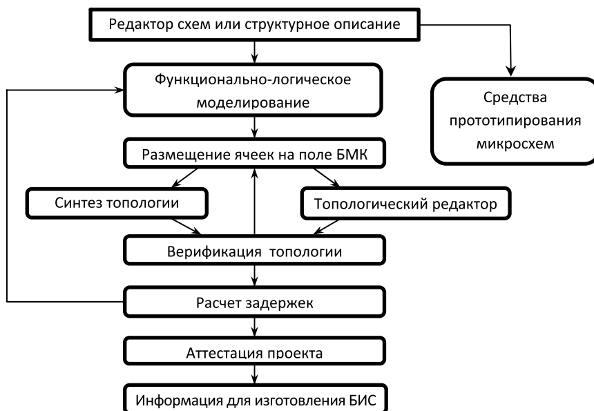
Рис. 1.1. Структурная схема САПР БИС «Ковчег 3.04»
