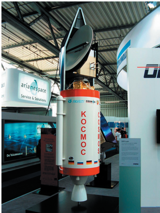
Рис. 1.5. Модель немецкого разведывательного спутника SAR-Lupe внутри ракеты «Космос-3М»
