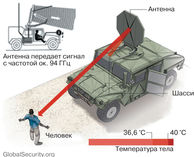
Рис. 1.12. Принцип воздействия ADS
