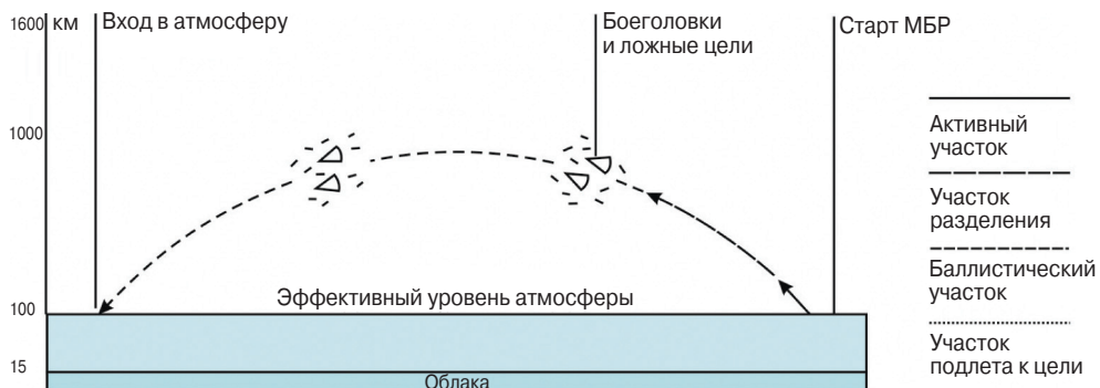
Рис. 1.1. Элементы траектории межконтинентальной баллистической ракеты
