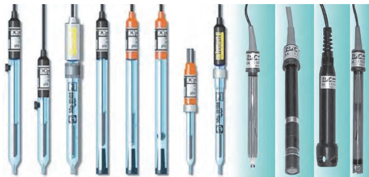
Рис. 1.11. Конструктивное исполнение металлических и мембранных электродов
