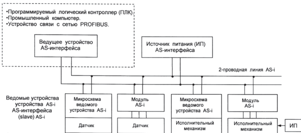
Рис. 1.14. Схема подключения устройств к AS-интерфейсу
