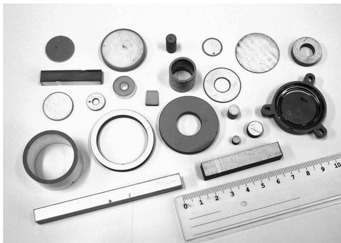
Рис. 2.1. Пьезокерамические элементы для ПЭАП
