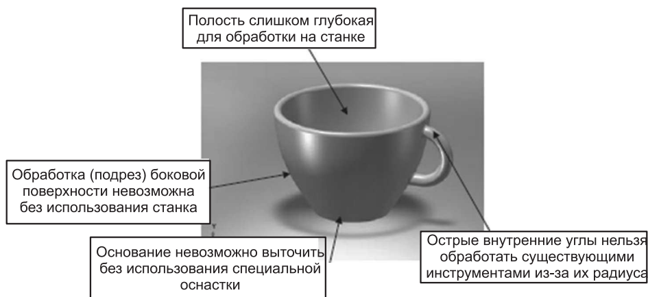
Рис. 1.3. Поверхности, обработка которых представляет проблему для станков с ЧПУ
