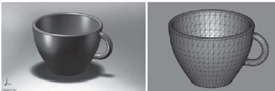
Рис. 2.2. Модель, выполненная в среде САПР (слева) и преобразованная в STL формат (справа)
