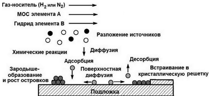
Рис. 1.1. Основные процессы, сопровождающие рост ЭС при МОСГЭ
