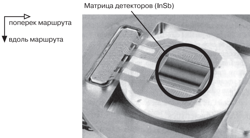
Рис. 1.18. Двумерная матрица детекторов аппаратуры HYDICE. Размер каждого детектора равен 40 мкм; суммарное число детекторов в матрице равно 67 200. Для учета энергетических различий в разных частях видимого и коротковолнового ИК-спектра (рис. 1.6) матрица разделена на три области (400—1000, 1000—1900 и 1900—2500 нм) с разным коэффициентом электронного усиления (см. гл. 3). Снимки предоставлены У. Раппопортом, компания «Гудрич электрооптикал системз» (Goodrich Electro-Optical Systems)
