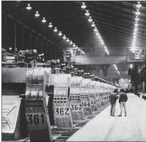
Рис. 1.10. Серия электролизеров для производства алюминия (с разрешения «Comalco Ltd.»)
