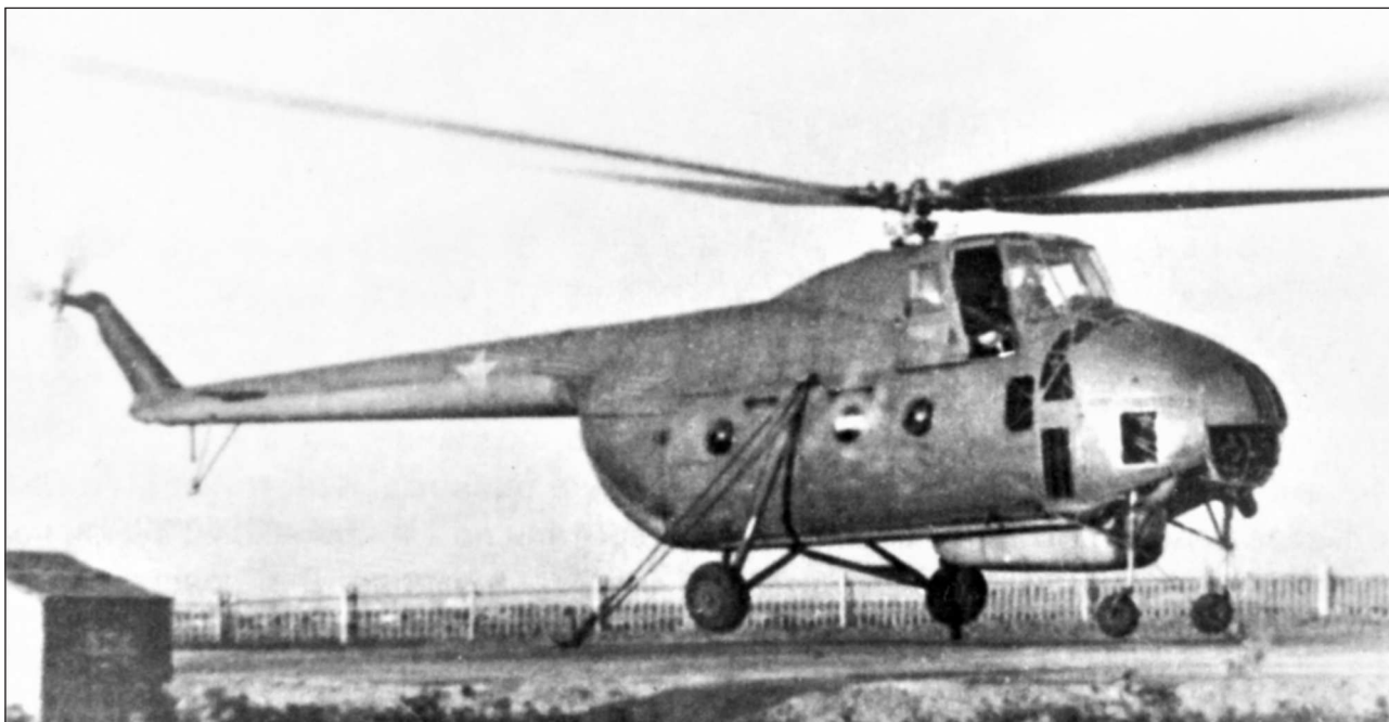
Испытание первого прототипа Ми-4 без шумопламяглушителей на привязи
