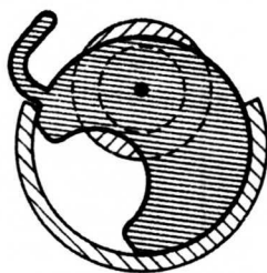
Рис. 51. Карабин Верндля 1873–1877 гг. с крановым затвором:
