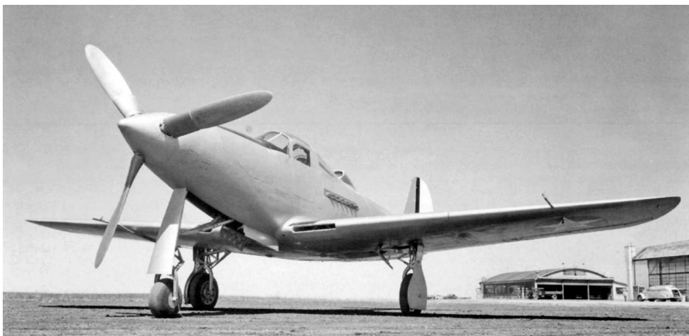
XP-39В весной 1940 г. Размеры всасывающего патрубка двигателя увеличены, изменены щитки носовой стойки шасси
