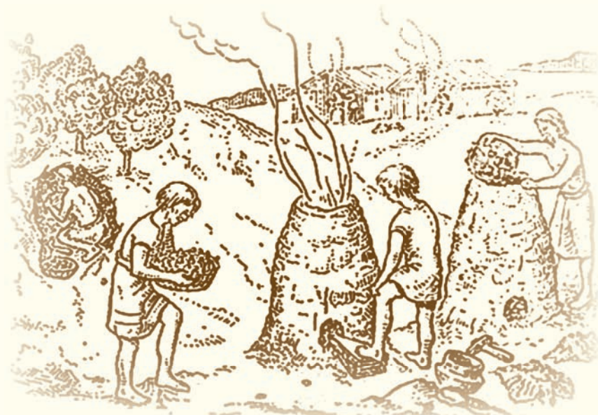
Сыродутная печь представляла собой полое сооружение из камней, обмазанных глиной, или целиком из глины. В стенах были предусмотрены отверстия для раздувания мехами
