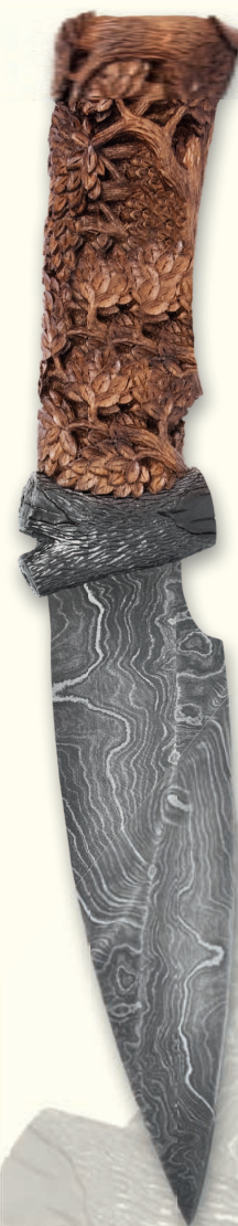
Охотничий нож с клинком из неоднородной стали — булата
