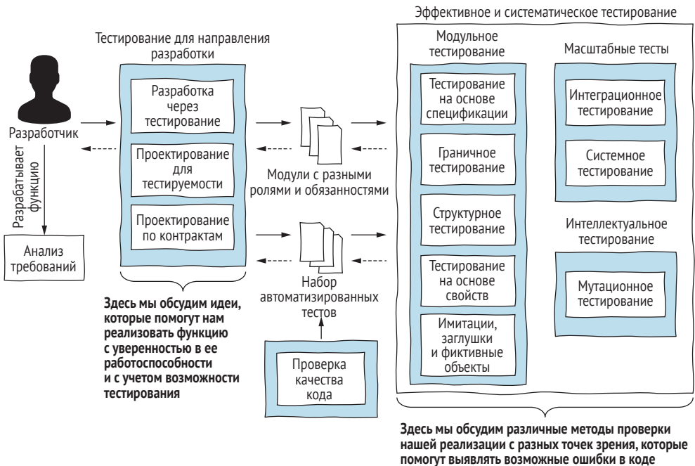
Рис. 1.4 Рабочий процесс разработчика, применяющего эффективное и систематическое тестирование. Стрелки указывают на итеративный характер процесса; разработчики могут переключаться между различными приемами по мере накопления знаний о разрабатываемой и тестируемой программе
