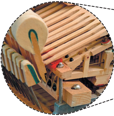
△ Молоточки, которые вызывают звук, ударяя по струнам
