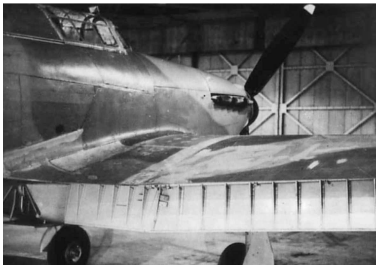
Проверка выпуска посадочных щитков
