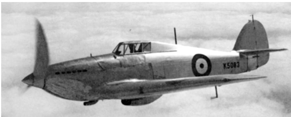
Эта же машина после доработки сфотографирована на испытаниях в Мартлшем в 1937 г. Сняты подкосы стабилизатора, изменен радиатор, установлены вооружение и радиостанция
