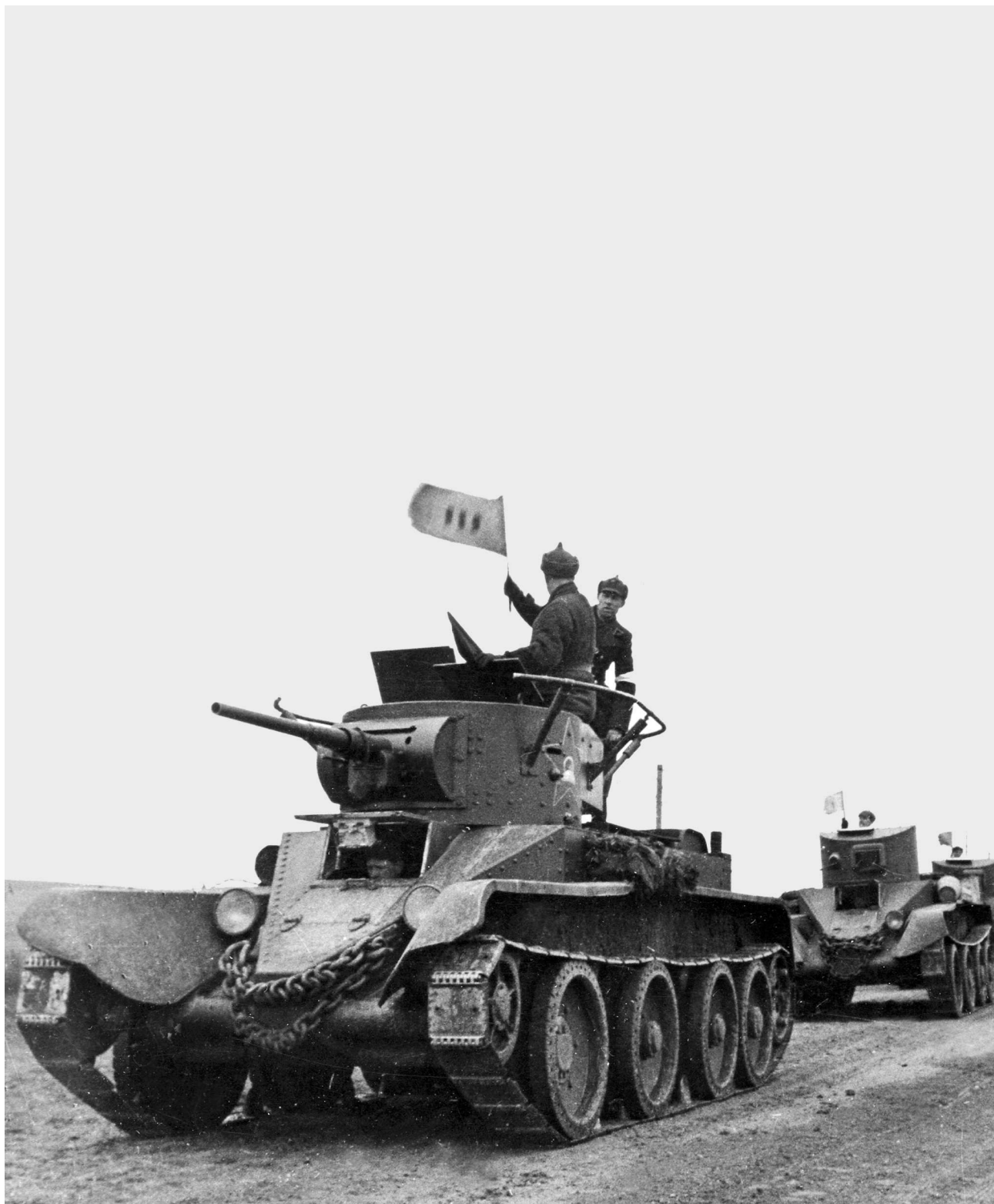
Учения 5-го механизированного корпуса, 1935 год. Во главе колонны радиыйный танк БТ-5, за ним БТ-2. Судя по флажку, это может быть 3-й батальон бригады. Обратите внимание на эмблему на башне БТ-5 (ЦМВС).
