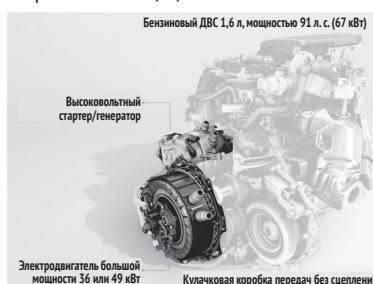
Рис. В.9. Пример последовательно-параллельной гибридизации после трансмиссии; заряжаемый и незаряжаемый электромобили (источник: Renault)
