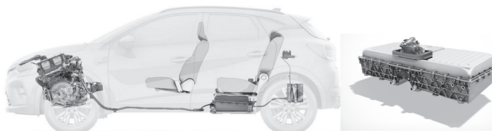
Заряжаемый от электросети гибрид Renault Capture e-Tech Hybrid и батарея 400 В, 9,8 кВт·ч
