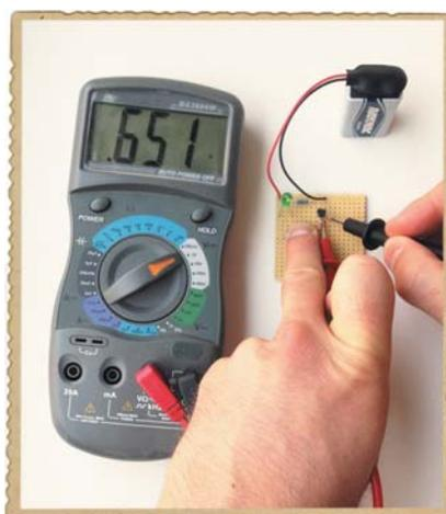
мультиметра должно быть близким к нулю. Теперь приложите палец к датчику и повторите измерение. Мультиметр должен показать около 0,7 В.
