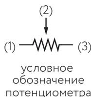
Условное обозначение потенциометра показывает, как потенциометр работает, и обозначает функции трех его выводов. Сопротивление между выводами 1 и 3 имеет некоторое постоянное значение, указанное на корпусе потенциометра. Если на корпусе потенциометра написано  $10\text{ k}\Omega$ , сопротивление между его выводами 1 и 3 равно  $10\text{ k}\Omega$ .
