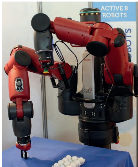
Рис. 1.7. Робот-манипулятор Baxter от Rethink Robotics (Источник: Baxter на выставке Innorobo, © Ксавье Капе (Xavier Caré)/Wikimedia Commons [CC-BY-SA 4.0 ( https://creativecommons.org/licenses/by-sa/4.0/ )])
