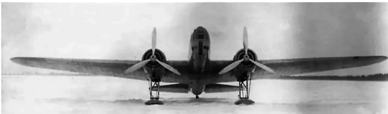
Второй ДБ-3 малой серии на лыжном шасси на государ- ственных испы- таниях, ноябрь 1936 г.
