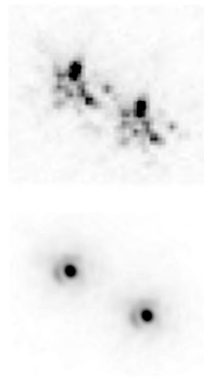
Рис. 10. Пример метода удачных экспозиций на 2,5-метровом телескопе NOT: вверху — одиночное изображение двойной звезды, полученное с короткой экспозицией; внизу — сумма лучших отобранных из серии экспозиций после центрирования. (Baldwin et al., A&A, 2001).
