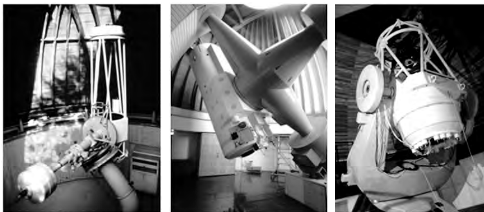
Рис. 4. Примеры телескопов на немецкой (слева), английской (центр) и вилочной монтировке.
