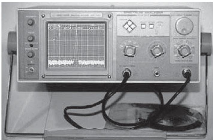
Рис. 6.5. Внешний вид анализатора спектра АКТАКОМ АКС-1101
