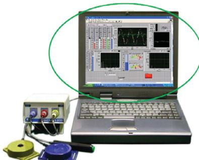
Понятно, что изменение лицевой панели прибора, например добавление еще одной лампочки или ручки управления, – довольно долгое и трудоемкое занятие. А на экране монитора можно легко и быстро менять элементы, добавлять их или убирать, изменять дизайн.
