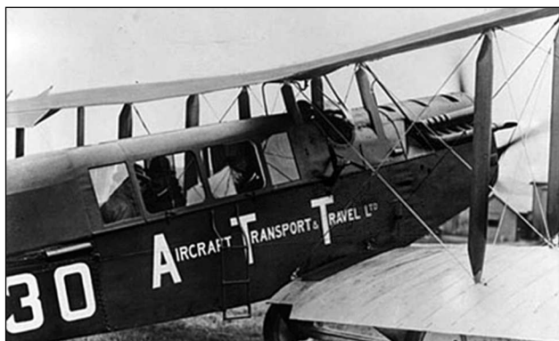
Хотя закрытый «лимузин» DH.16 компании «А.Т.&Т.» позволял пассажирам в полете находиться в относительно комфортных условиях, посадка и высадка требовали известной сноровки
