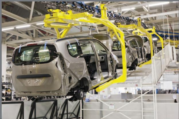
В 1910-х гг. именно в автомобилестроении широкое распространение получила конвейерная система сборки.
