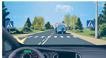
Дорожные знаки 5.15.1, 5.19.2 и разметка 1.14.1 показывают место расположения пешеходного перехода
