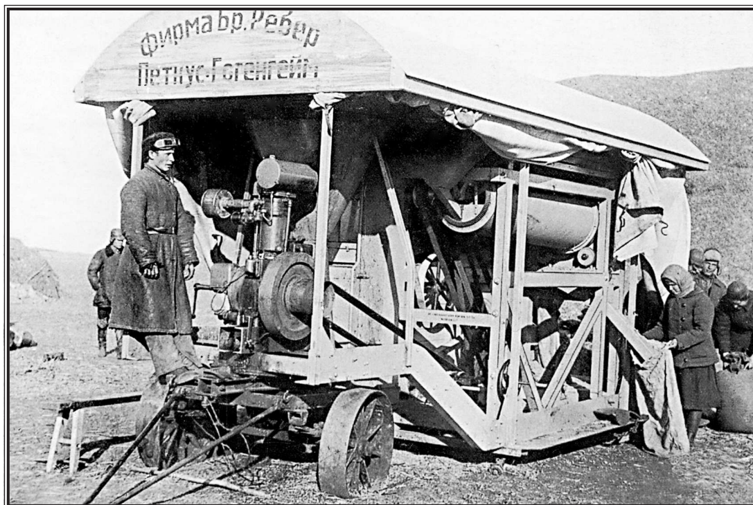
Машина для обмолота зерна фирмы «Братья Рёбер».
