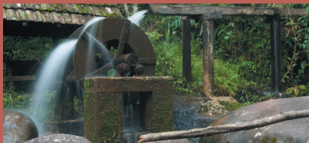
Водяное колесо с верхней подачей воды.
