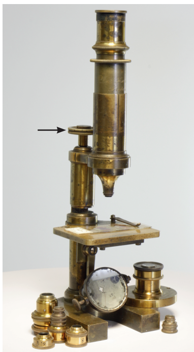
Рис. 1.2. Усовершенствованный микроскоп Е. Гартнака (60–70-е годы XIX в.). Винт (стрелка), с помощью которого осуществляется тонкая фокусировка; грубая фокусировка достигается непосредственным передвижением тубуса в гильзе
