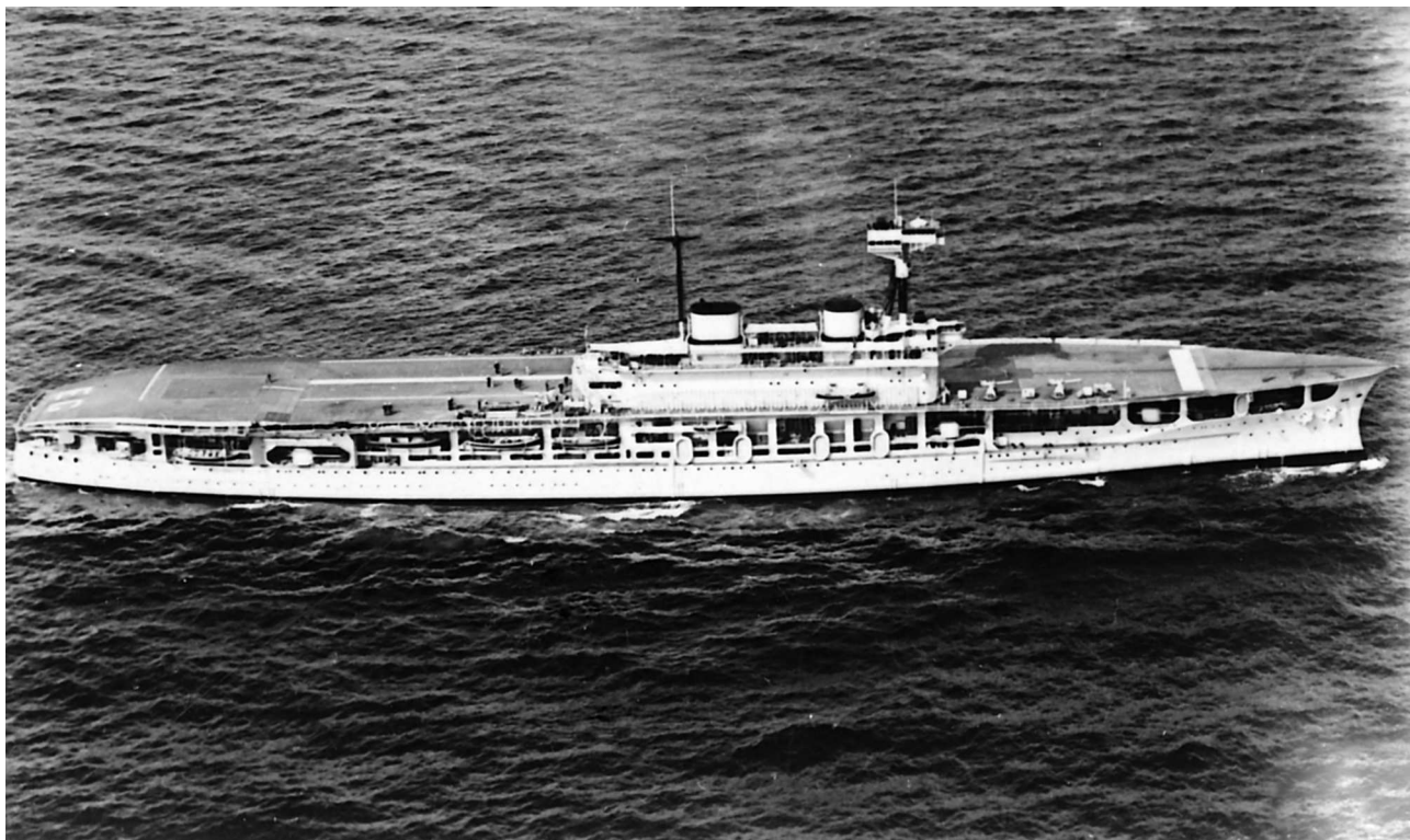
«Игл» в середине 1920-х гг. Корабль несет исходный состав вооружения, включающий пять 102-мм зениток, на грот-мачту добавлена стеньга, на полетной палубе имеется продольный аэрофинишер. Серпообразный форштевень, стойки, поддерживающие полетную палубу, и две дымовые трубы придавали авианосцу неповторимый силуэт
