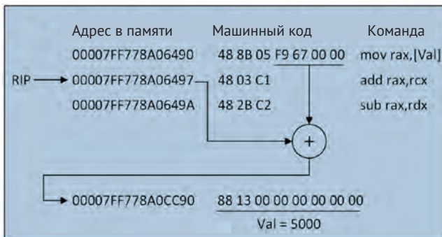
Рис. 1.5. Вычисление эффективного адреса относительно RIP
