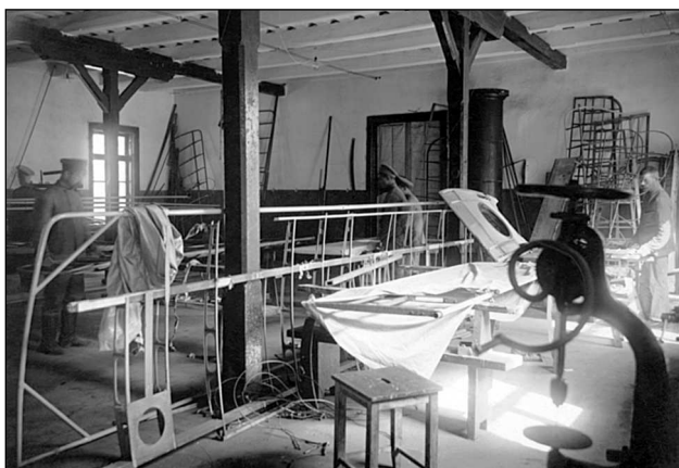
Сборка деревянных крыльев и раскрой полотняной обшивки
