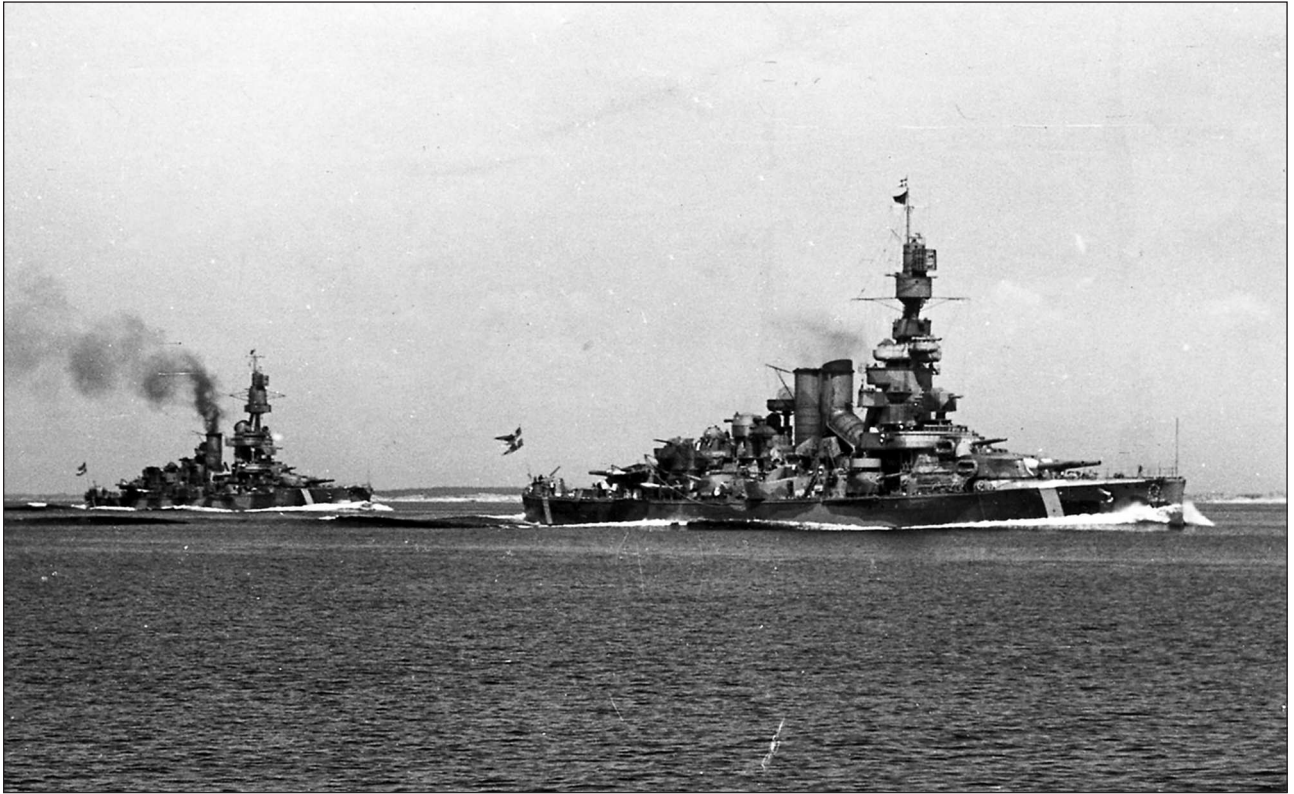
«Сверье» (справа) и «Дrottнинг Виктория» в 1945 г. Представители последней и самой мощной серии шведских броненосцев. Оба корабля несут антенны РЛС на фок-мачтах и камуфляжную окраску с белой «полосой нейтралитета» в носовой части
