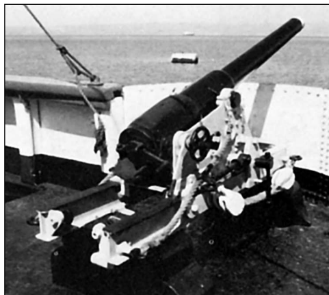
120-мм казнозарядное орудие «Уаскара» на станке с передним штыром, установленное в 1882 г.
