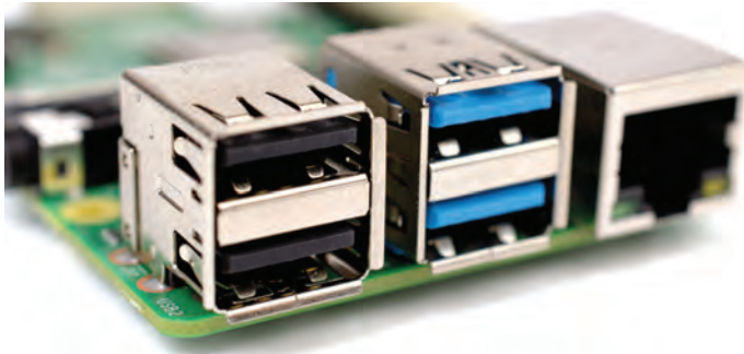
Рис. 1.6: USB-порты платы Raspberry Pi
